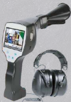
Detector de Fugas
