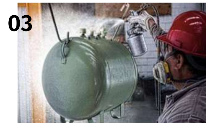
Aplicación de sellador
