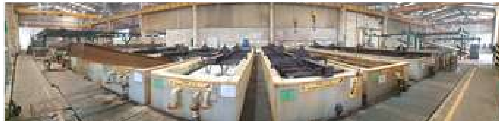
Preparación de la superficie Pre-tratamientos previos al galvanizado
