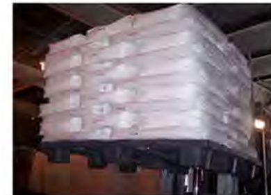
Diseño logístico moderno / 4 WAY Pallet Patín Hidráulico o Montacargas por los 4 lados.
