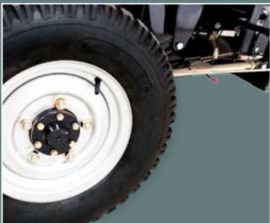
Llantas 5x12 de trabajo pesado y diferencial reforzado de 5 birlos
