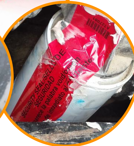
Etiqueta de seguridad en filtro
