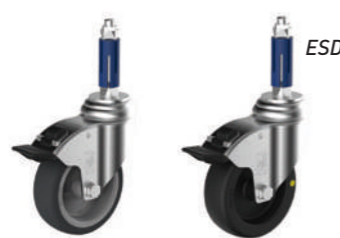
TF-125 Rueda giratoria de inserto con freno Ø 100mm, carga máxima 100 Kg DISPONIBLE en ESD: ref. TF-125 ESD
