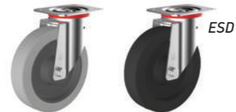
PP-125 Rueda giratoria de plato Ø 100mm, carga máxima 180kg DISPONIBLE en ESD: ref. PP-125 ESD
