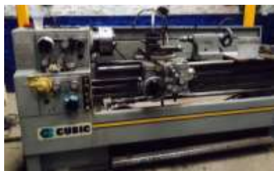
Torno de 1 mt ½ entre puntos con bolteo de 16", escote a 22" cion chuck de 10" y terminados espejo
