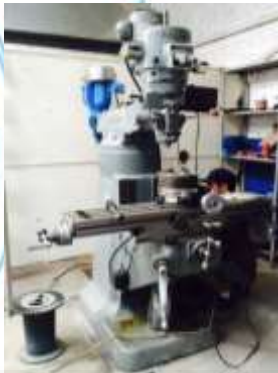
Perfiladora con mesa de 42"x 9", regleta eslopio para 4" en cuñeros y avance electrónico.
