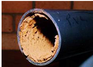
Incrustaciones minerales en tubería de PVC.
