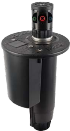
G885C Altura de emergencia: 9,5 cm Altura total: 30 cm Diámetro de la tapa: 18 cm Rosca: 1½" hembra ACME
