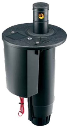
G835E Altura de emergencia: 8 cm Altura total: 30 cm Diámetro de la tapa: 18 cm Rosca: 1½" hembra ACME
