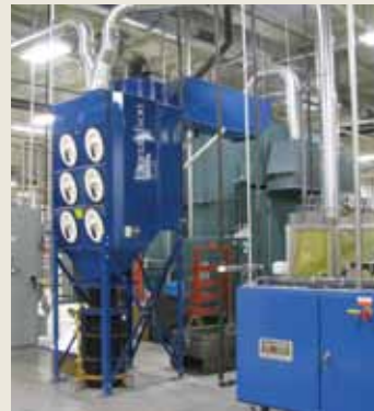
DFO Molino de caucho 2,500 cfm
