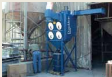
DFO Fabricación de cemento para techos 3,000 cfm
