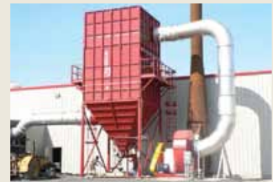
MB Procesamiento de cristal 25,000 cfm
