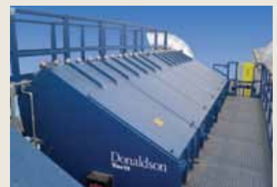
CPC Transportador de disparo de grano 18,700 cfm
