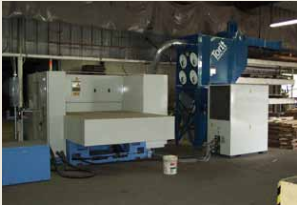
DFO Corte Láser 3,100 cfm
