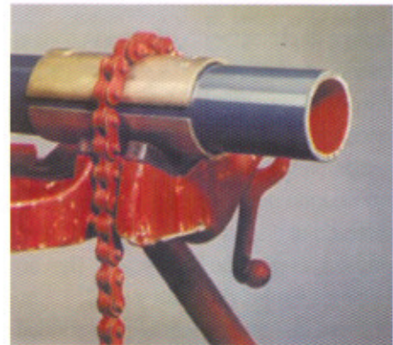
Ponga especial cuidado a fin de evitar daños al recubrimiento exterior del tubo si utiliza un tornillo de banco con cadena.
