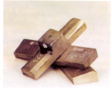
La mordaza 3 está diseñada para proteger los tubos con recubrimiento contra daños ocasionados por mordazas con tornillo de banco durante el doblado.
