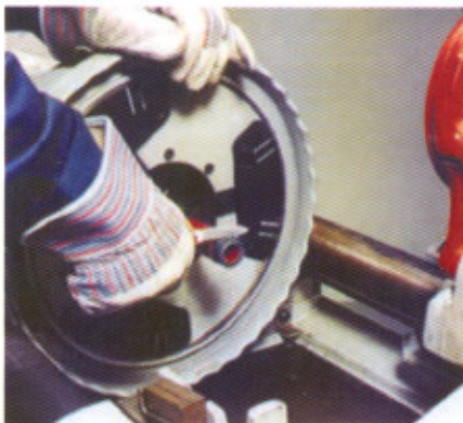
El recubrimiento de PVC quizá necesite ser cortado al estilo de un lápiz para que los dados engranen con el tubo conduit.
